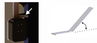
Figura 4: Fixar o "Suporte Dobrado" na calha através de parafusos e após fixar com ponto de solda no portão, para reforço de sustentação do movimentador. Obs.: O "Suporte Dobrado" sai de fábrica reto e o cliente ajusta o ângulo de fixação conforme o portão.
