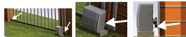
Figura 5: Fixar os batentes de final de curso nas duas extremidades da cremalheira.
